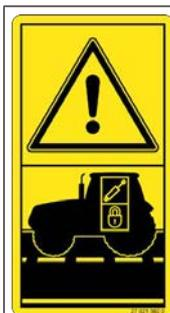
**Опасность из-за незаблокированных управляющих клапанов трактора**
