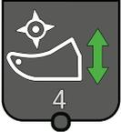
4 | <ul style="list-style-type: none"> <li>Предварительно выбрать подборщик, чтобы можно было с помощью управляющего устройства установить подборщик в транспортное/рабочее положение, <i>см. Страница 92</i></li> <li>Предварительный выбор днища подающего ротора, чтобы можно было с помощью управляющего устройства поднять/опустить днище подающего ротора, <i>см. Страница 97</i></li> </ul> |
