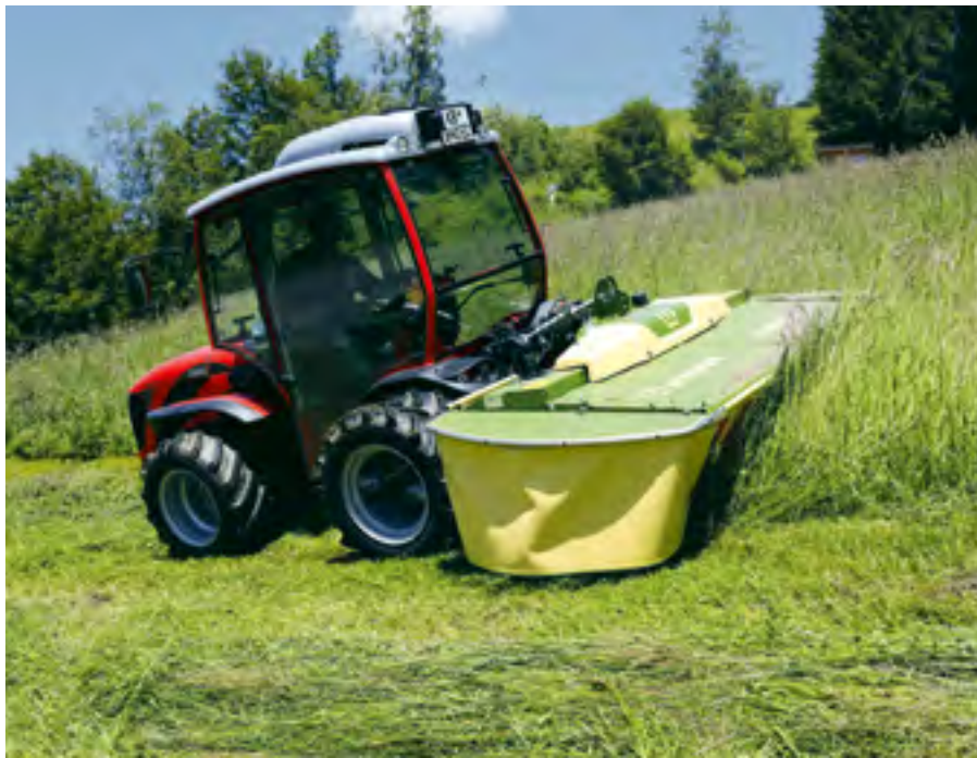
L'«EasyCut F 280» est l'une des deux faucheuses de la ligne «Highland» de Krone. Elle s'attèle sans triangle Weiste, très près du véhicule porteur. Le poids de son châssis a été optimisé. Photos : Johannes Paar et Roman Engeler
