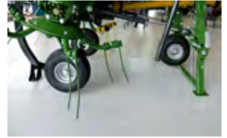
Avec un support frontal double et une béquille arrière mobile, les faneuses bénéficient d'une construction autoportante qui facilite leur remisage.
