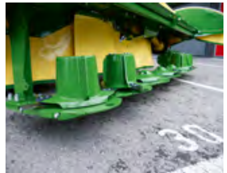
Die äusseren beiden Mähtrummeln mit zwei und vier Schlagleisten sollen für einen sicheren Gutfluss sorgen.
