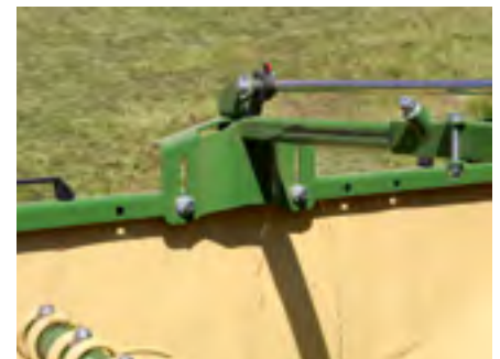
Optional kann das Schwadttuch hydraulisch verstellt und geklappt werden.
