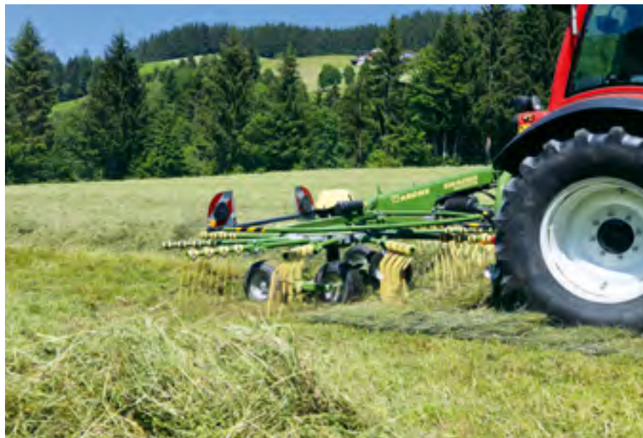
Die alpinen Schwader basieren auf dem Konzept der «Swadro», sind aber leichter und niedriger gebaut.
