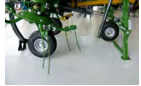
Die Kreiselheuer können freitragend, auf einer Doppelstütze vorne und einer Stütze hinten, abgestellt werden.
