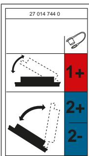
Наклейка отмечает возможные гидравлические подключения машины. Дополнительная информация о подсоединении гидравлических шлангов: [см. Страница 53](#) и [см. Страница 43](#)
