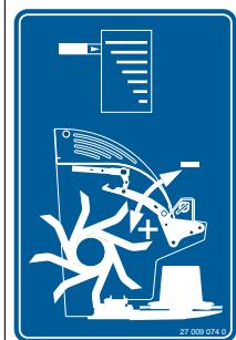
Наклейка указывает на то, что степень плющения можно регулировать путем перестановки подготовительного щитка с помощью рычага.
