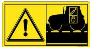
**Опасность из-за незаблокированных управляющих клапанов трактора**
