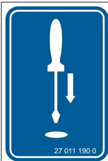
Эта наклейка указывает на то, что кожухи защиты могут быть открыты с помощью отвертки.
