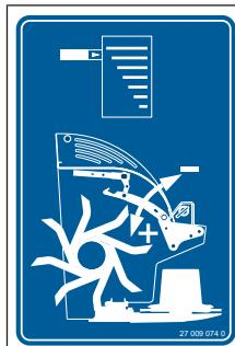
Nálepka informuje o tom, že lze stupeň úpravy měnit přestavením upravovacího plechu pomocí páky.
