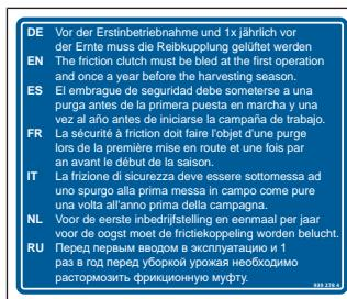
Tato nálepka uvádí, že se musí třecí spojka před prvním uvedením do provozu a jednou za rok před sezónou provzdušnit.
