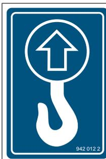
La machine comprend des points de levage identifiés par cet autocollant, [voir Page 175](#).
