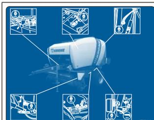
L'autocollant indique les points de lubrification de la machine qui doivent être lubrifiés selon les intervalles de maintenance stipulés, voir Page 190.
