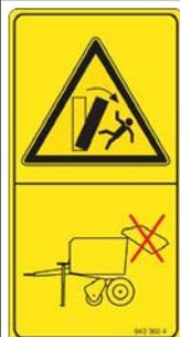
**Danger dû au mouvement inopiné de la machine lors de l'ouverture de la trappe arrière**
