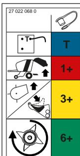
Cet autocollant indique les raccords hydrauliques possibles de la machine. Pour davantage d'informations sur l'accouplement des flexibles hydrauliques : voir Page 65.
