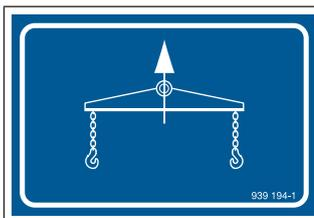
Il faut utiliser une traverse de levage si la machine est soulevée, voir Page 175.
