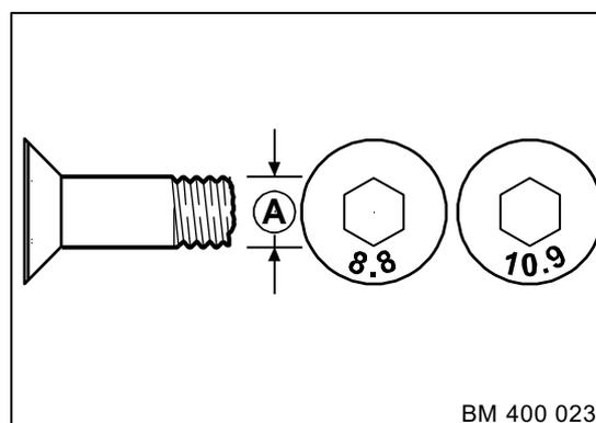
**12.3.4 Couples de serrage pour les vis obturatrices et les soupapes de purge sur les boîtes de vitesses**
