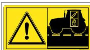
**Nebezpečí při nezajištěných řídicích ventilech traktoru**
