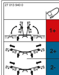
Наклейка отмечает возможные гидравлические подключения машины. Дополнительная информация о подсоединении гидравлических шлангов: [см. Страница 55](#).
