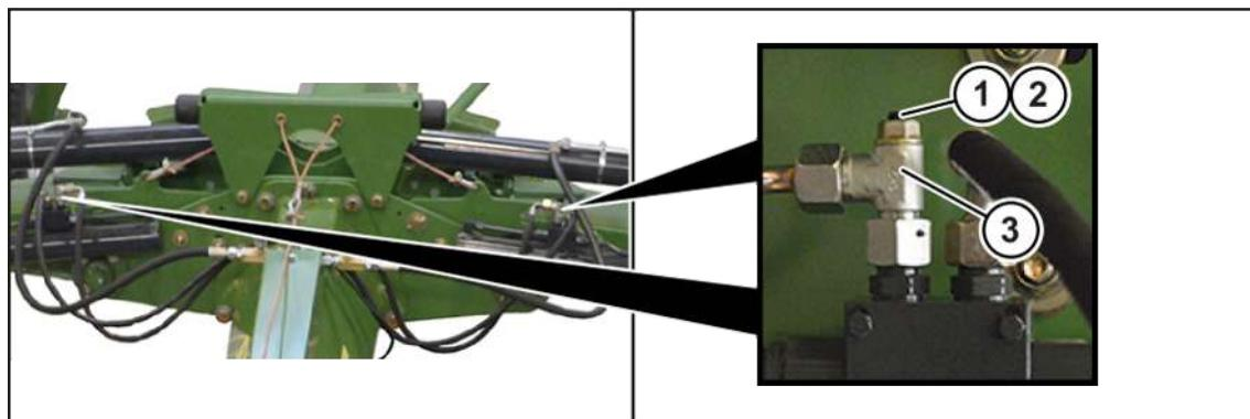
При завинчивании установочного штифта (2) расход масла уменьшается, в результате чего скорость выдвижения для регулировки рабочей ширины/ширины валка замедляется.
