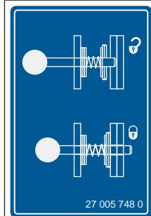
Наклейка находится на устройствах блокировки со стяжным болтом и показывает, какая блокировка открыта или закрыта.
