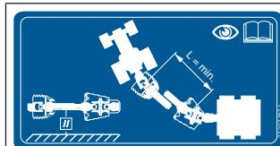
Наклейка расположена рядом с карданным валом и указывает, что при регулировке карданного вала должна быть соблюдена инструкция по эксплуатации, *см. Страница 46*.
