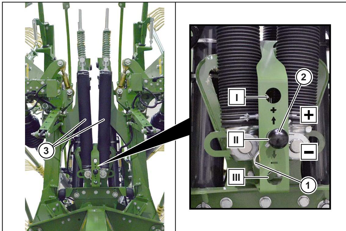
Посредством пружин растяжения (3) нагружаются или разгружаются роторы и регулируется давление на почву.
