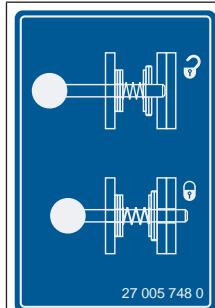
Tato samolepka se nachází na zajišťovacím mechanizmu vytahovacím čepem a uvádí, jak se zajišťovací mechanizmus otevřívá nebo zavírá.
