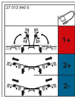
Samolepka ukazuje možné hydraulické spoje stroje. Pro další informace k připojení hydraulických hadic: *viz Strana 49*.
