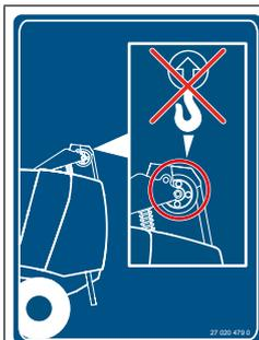
Aucun engin de levage ne peut être accroché sur le bras oscillant pour soulever la machine. Cela peut endommager la machine.
