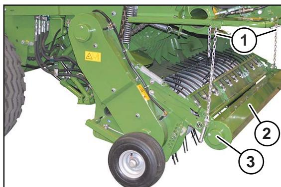
Válcový přidržovač (3) vede sklizňový produkt při návodu přes sběrač.
