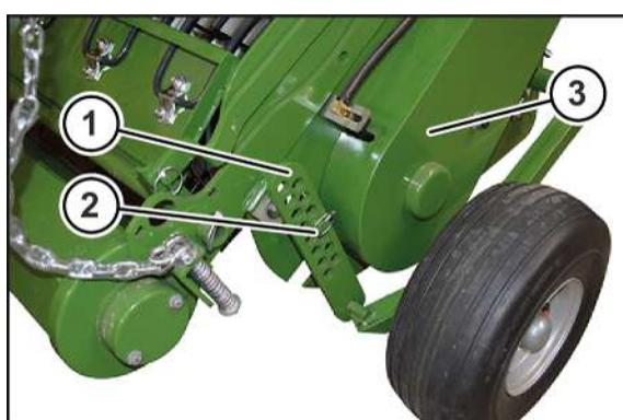
Pracovní výšku sběrače (3) je třeba nastavit tak, aby byla vzdálenost prstů od země asi **20–30 mm**. Pracovní výšku sběrače (3) je třeba také přizpůsobit terénu.
