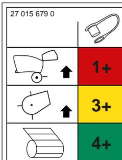
Cet autocollant indique les raccords hydrauliques possibles de la machine. Pour davantage d'informations sur l'accouplement des flexibles hydrauliques : [voir Page 58](#).
