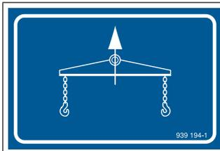
Il faut utiliser une traverse de levage si la machine est soulevée, voir Page 85.
