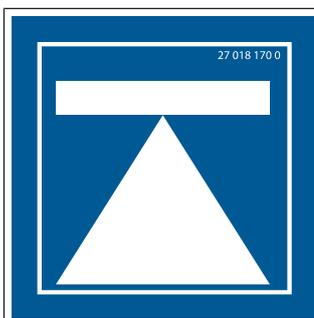
La machine comprend des points d'appui du cric identifiés par cet autocollant, voir Page 130.
