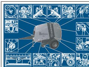
L'autocollant indique les points de lubrification de la machine qui doivent être lubrifiés selon les intervalles de maintenance stipulés, [voir Page 95](#).
