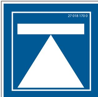
La machine comprend des points d'appui du cric identifiés par cet autocollant, voir Page 140.
