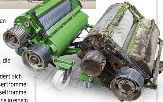
250er Cracker. Hier spielt die größere Reiboberfläche der Aufbereiterwalzen ebenso eine Rolle, wie die bessere Gutförderung und Annahme des Materials durch die Walzen. Im Vergleich ist beim Einsatz des größeren Crackers ein Mehrdurchsatz von 3,6 % bei 6 mm
