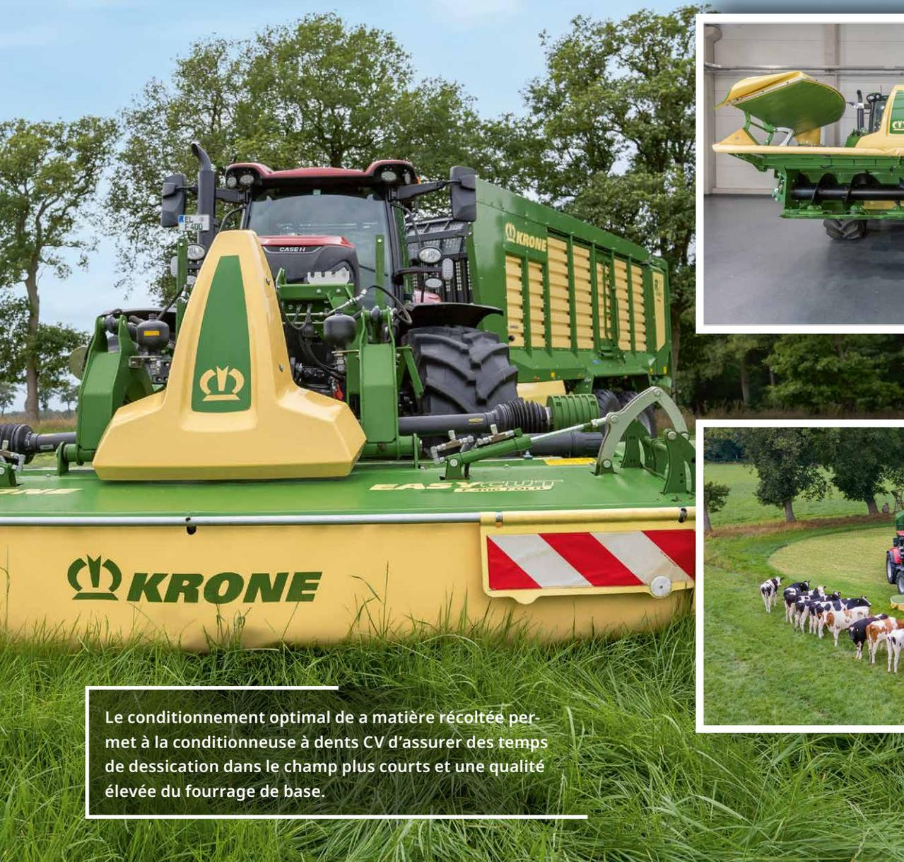
Le conditionnement optimal de la matière récoltée permet à la conditionneuse à dents CV d'assurer des temps de dessiccation dans le champ plus courts et une qualité élevée du fourrage de base.
