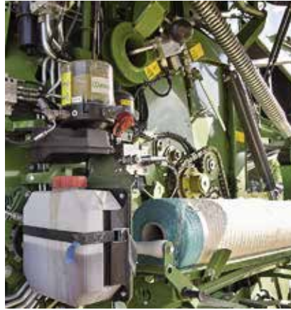
△ Eine Zentralschmieranlage sowie die Kettenschmierung gibt es serienmäßig.
