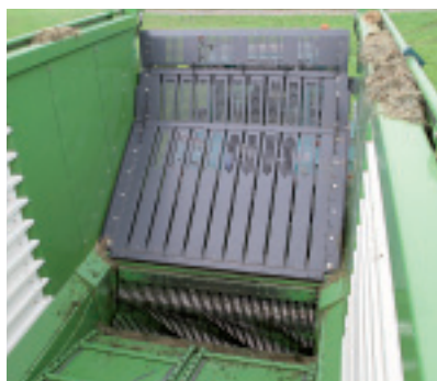
Die nach vorne geschwenkte Stirnwand erhöht das Ladevolumen um rund 4 m 3 .
