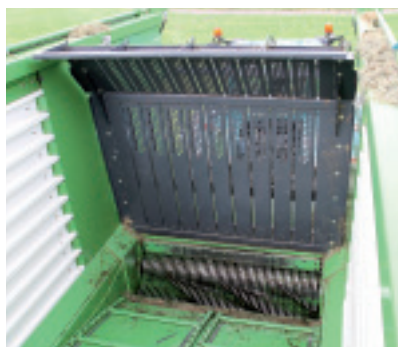
Die Ladeposition der schwenkbaren Stirnwand lässt sich am Terminal den Bedingungen anpassen.
