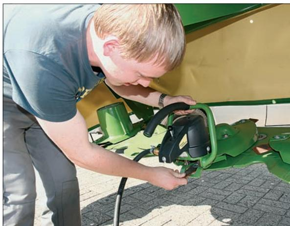
Mit dem Schnellwechselgerät „QuickChange“ dauert das Wechseln von Messerklingen nur noch halb so lang.
