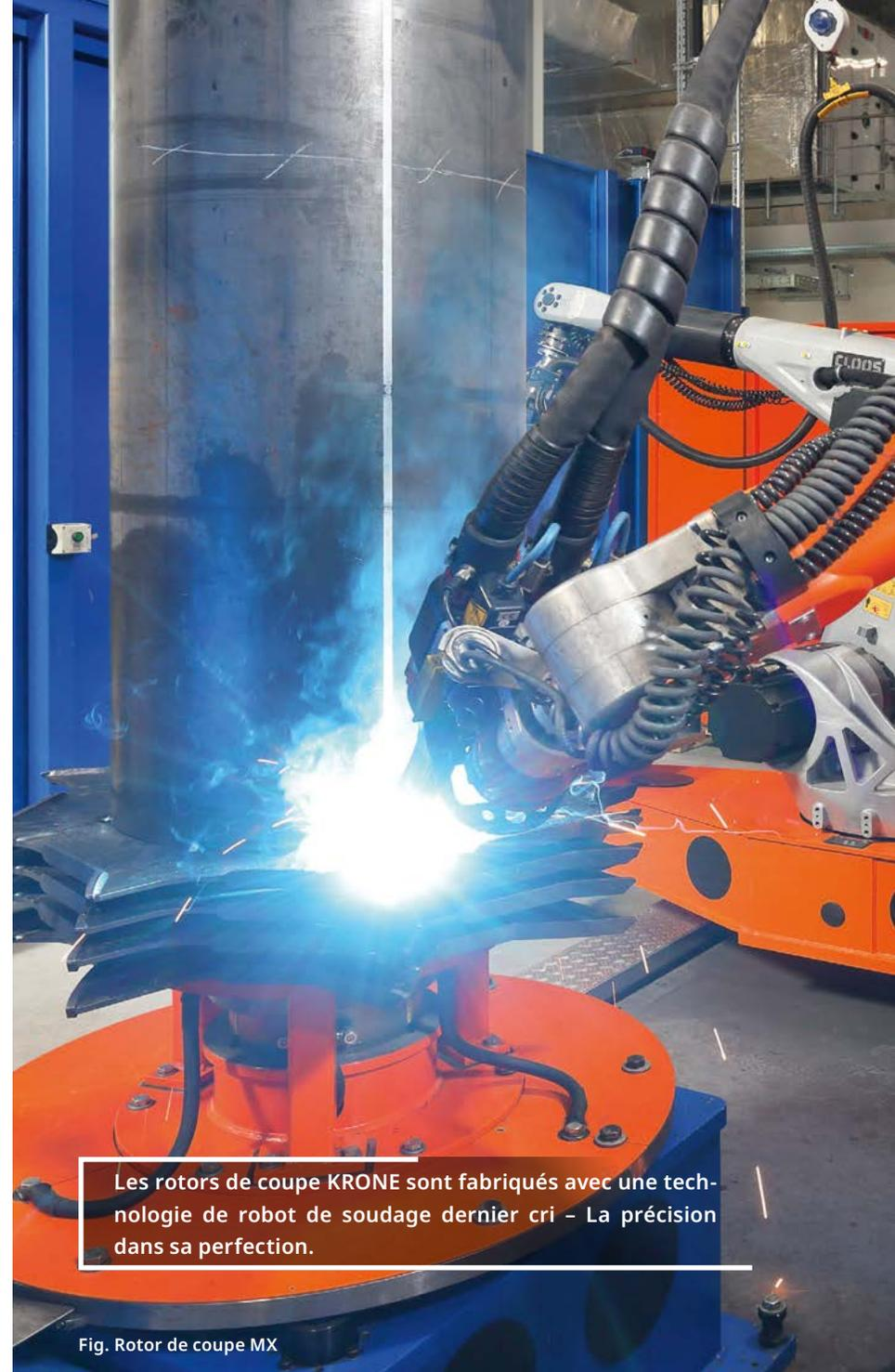
Les rotors de coupe KRONE sont fabriqués avec une technologie de robot de soudage dernier cri – La précision dans sa perfection.
