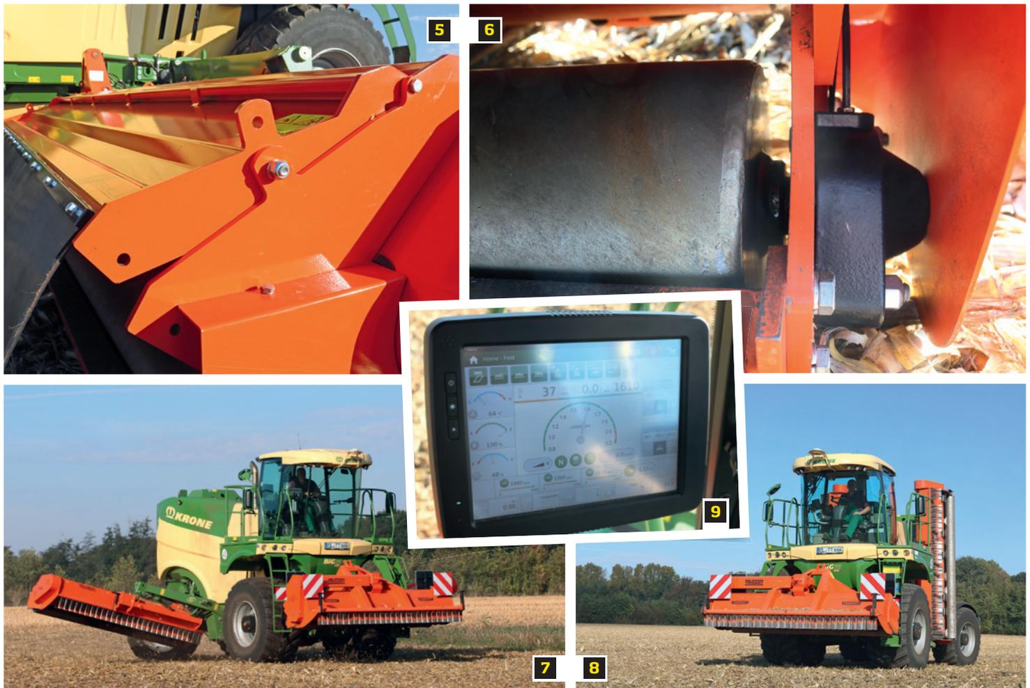
zahlen der Schlegelwellen wiedergegeben, welche höher liegen als die Drehzahlen der Mähwerke. Am Layout hat sich aber nichts verändert. Die hydraulische Schnitthöheneinstellung sowie die vollhydraulische Verstellung des Auflagedrucks sind von der Kabine aus ansteuerbar und von den Perfect Trigant Mulchern umsetzbar.
