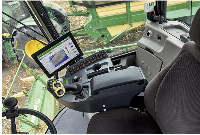
**Krone hat die Kabine deutlich überarbeitet. Neu an Bord ist auch der Farbmonitor mit Touch-Bedienung und Kameraeingängen.**
