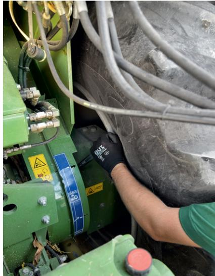
**Bei VariLOC lässt sich die Trommeldrehzahl per Planetengetriebe reduzieren.**
