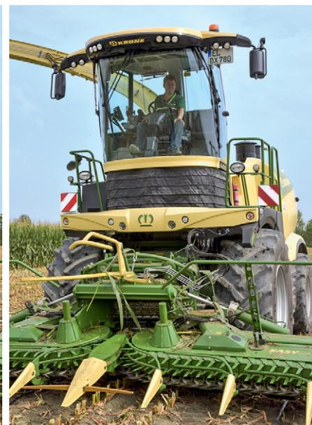
**Aufwärts für einen besseren Überblick:** Die Kabine lässt sich optional von der Ausgangsposition (links) hydraulisch 70 cm nach oben fahren.
