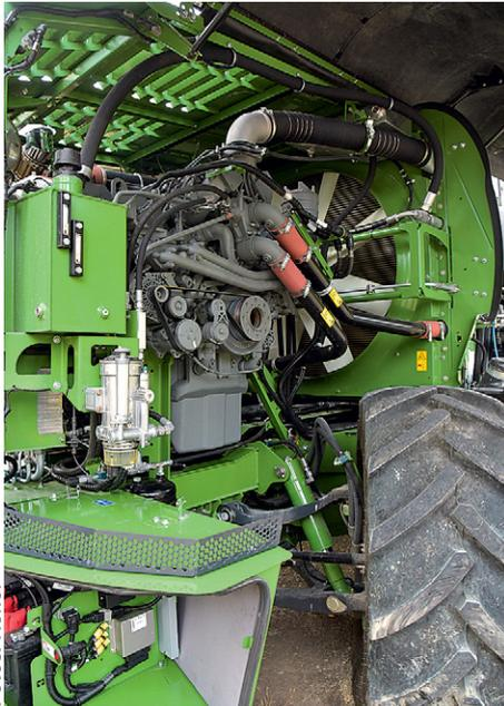
**Quer eingebauter Liebherrmotor und Einzelradaufhängung mit Radmotoren.**
