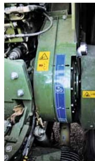
Mit dem Riemenscheibengetriebe lässt sich die Trommeldrehzahl in kurzer Zeit anpassen.
