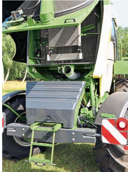
Das Kühlerpaket ist bis auf die Dimensionen bekannt und gut zugänglich geblieben.
