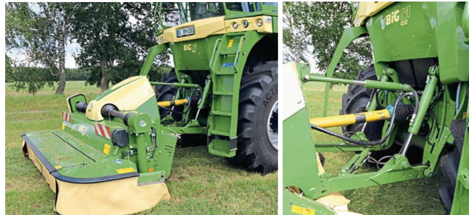
Keine Federn mehr: Der Auflagedruck vom Frontmähwerk lässt sich jetzt hydraulisch einstellen. Der Überschnitt wird automatisch bei Lenkbewegungen (auch am Hang) angepasst.
