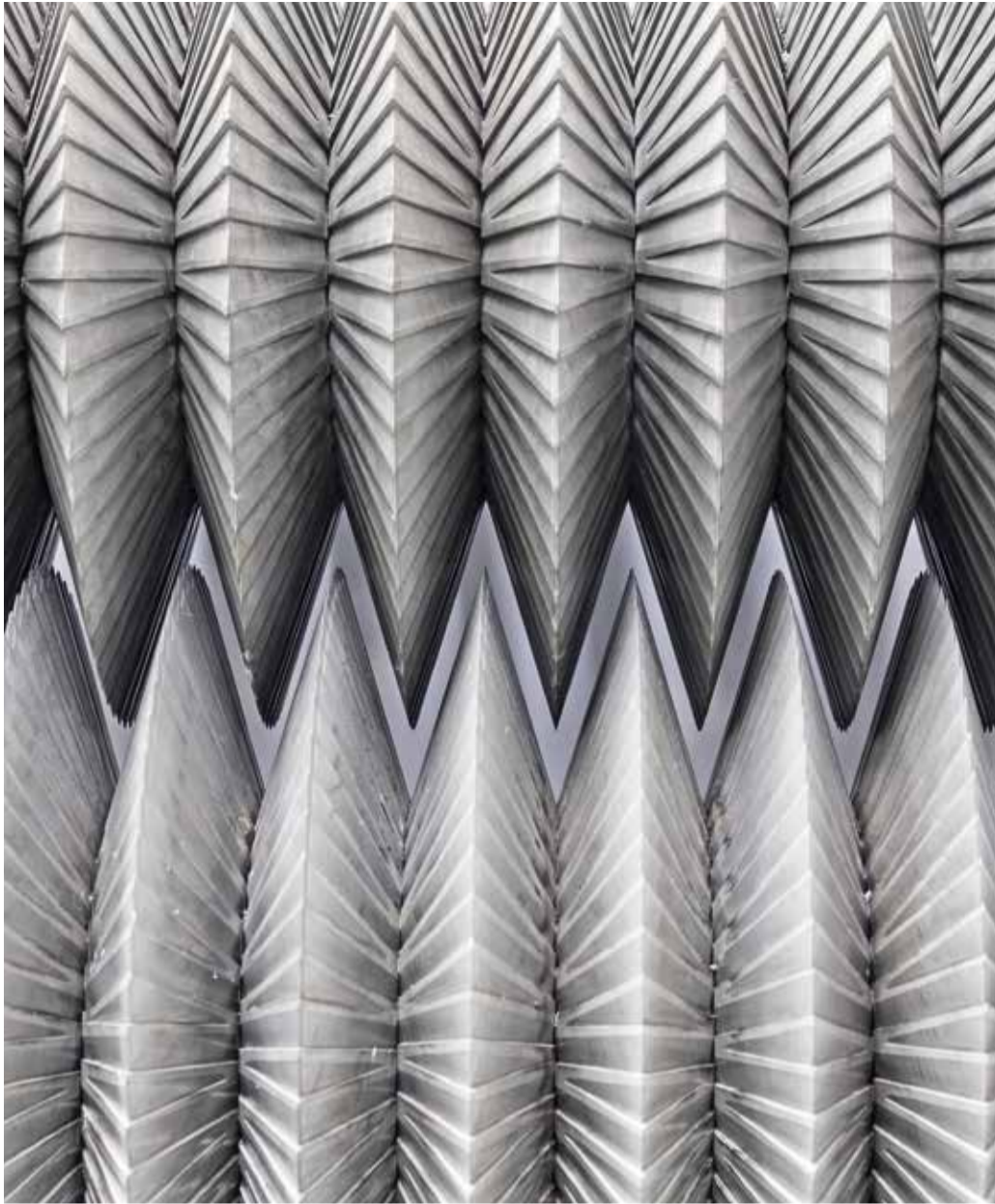
Der Scheiben-Conditioner hat ein großes Leistungsvermögen, er zerschlägt alle Körner und zerreibt auch die Maisstängel.
