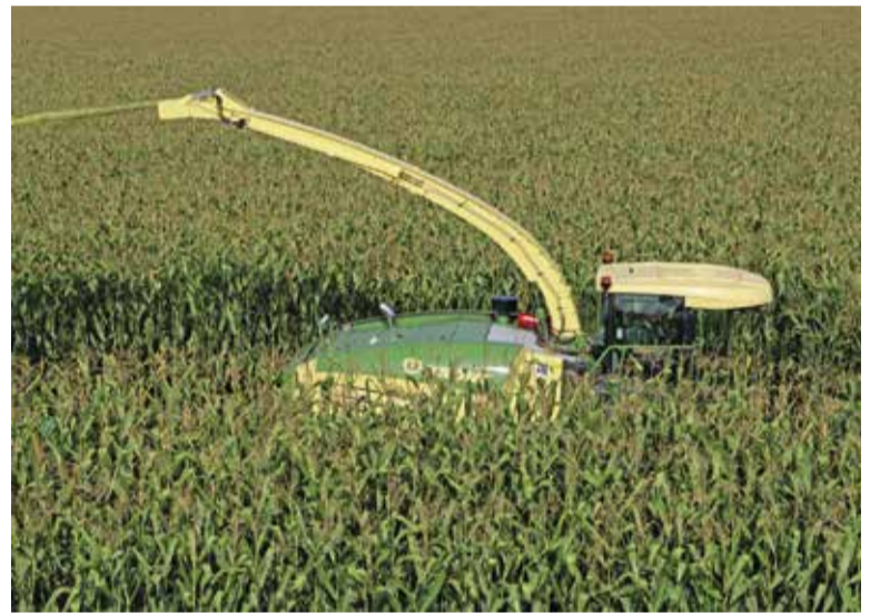
Das OptiMaize-Konzept von Krone ermöglicht es, mit dem BiG X-Häckslers innerhalb von 5 Minuten von 5 auf 30 mm Häcksellänge zu wechseln.
