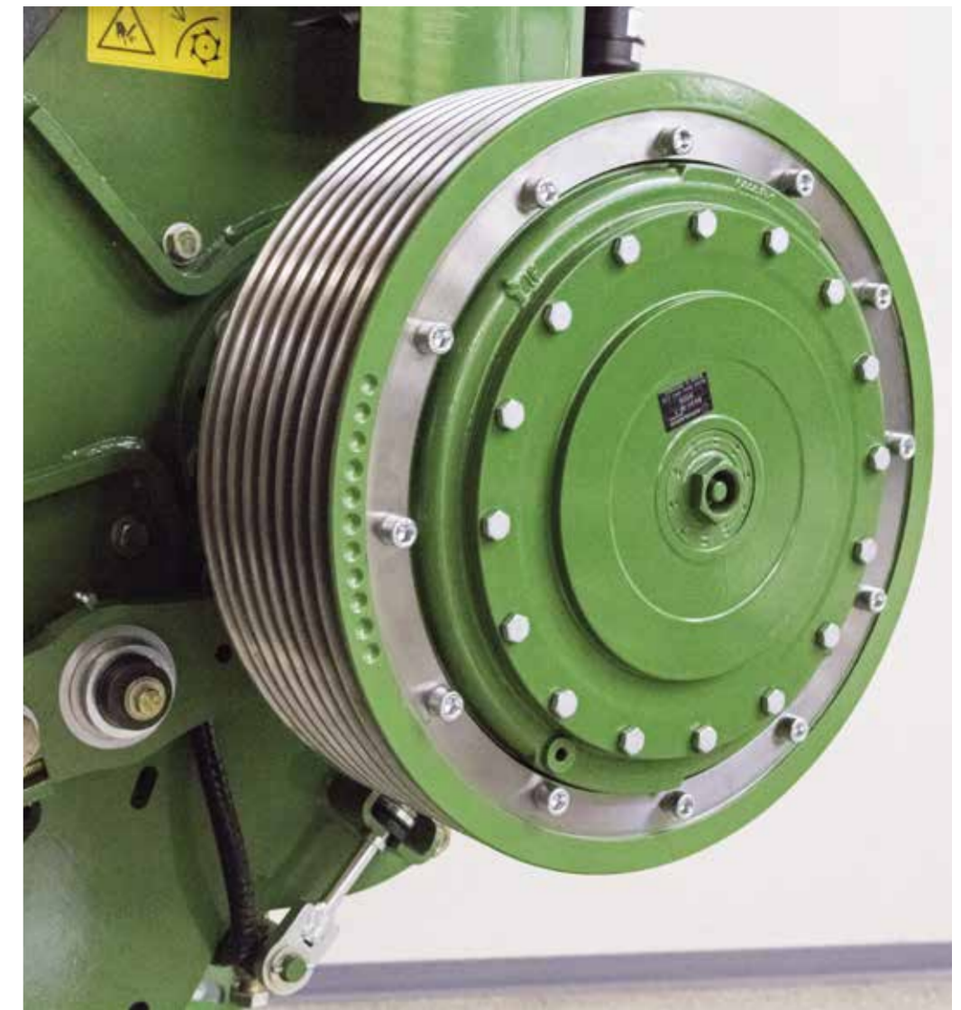
Eine zentrale Rolle in dem OptiMaize-System spielt der VariLOC-Antrieb. Mithilfe des in die Riemenscheibe der Häckseltrommel integrierten Planetengetriebes sind zwei unterschiedliche Geschwindigkeiten zu erzielen.
