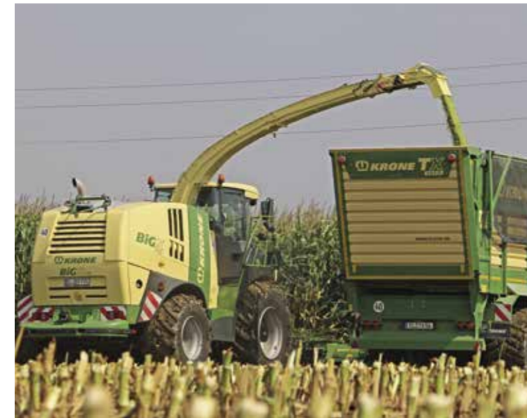
Das OptiMaize-Konzept ermöglicht es Lohnunternehmern, mit dem Krone BiG X Feldhäcksler Mais flexibel in jeder erwünschten Schnittlänge zu häckseln.
