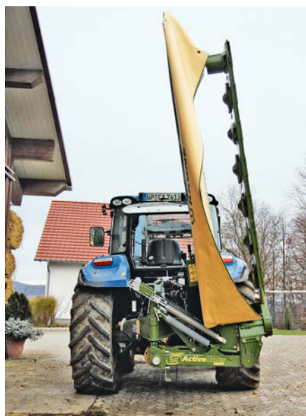
Für den Transport schwenkt der Mähbalken über die 90 Grad in die Senkrechte. Trotzdem genügt ein einfach wirkendes Steuergerät zum Klappen.
