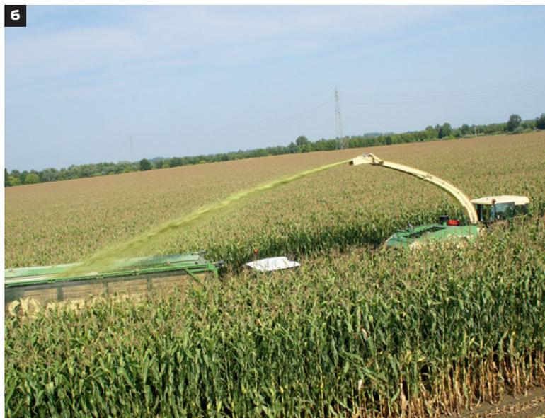
Im Grasmodus wird die Narbe geschont, indem kein Schlupf zugelassen wird. Im Mais wird ein wenig Schlupf zugelassen, damit sich der Reifen schön verzahnen kann. Auf Wunsch kann die Antriebsschlupfregelung auch komplett ausgestellt werden.
