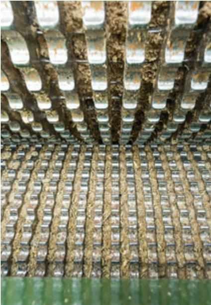
Die beiden Matrizenwalzen rollen aufeinander ab. Die Zahnprofilreihen greifen dabei in die Lochmatrizenreihen und dichten die Presskanäle gegeneinander ab.
