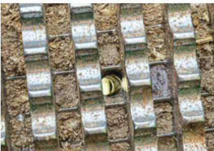
In den Presskanälen der Lochmatrizen mit 16 mm Durchmesser werden die Pellets geformt – bei bis zu 2000 bar Druck!
