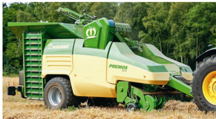
Hier der Premos 5000 im diesjährigen Einsatz. Die komplette Verarbeitung des Halmgutes von der Schwadaufnahme bis zum Abbunkern und Überladen der fertigen Pellets macht ihn zum ersten Pellet-Vollernter.
