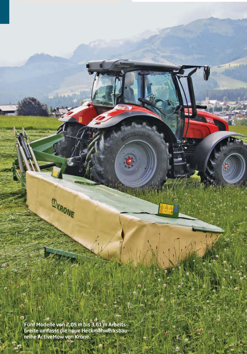
Fünf Modelle von 2,05 m bis 3,61 m Arbeitsbreite umfasst die neue Heckmähwerksbaureihe ActiveMow von Krone.
