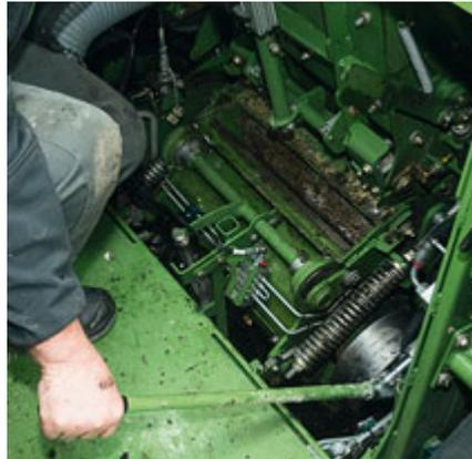
Beim Crackerausbau wird automatisch der Grasschacht in den Kanal geschoben.
