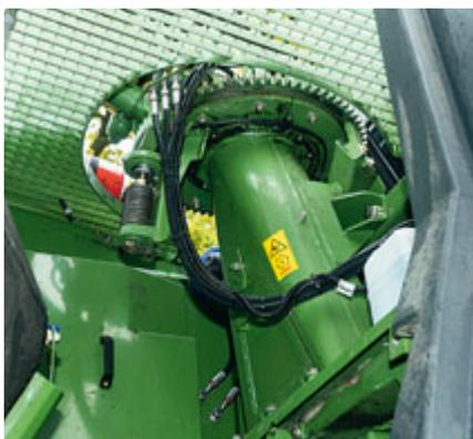
Das stabile Drehwerk mit mechanischer Anfahr-sicherung schwenkt den Turm um 210°.
