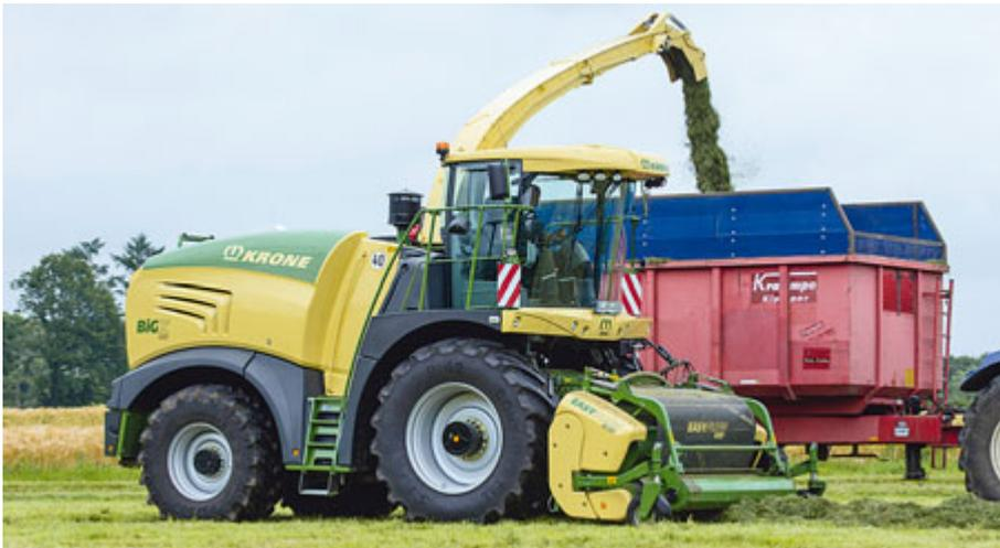
Die Pickup sammelt alles Futter auf – auch bei hohen Fahrgeschwindigkeiten.
