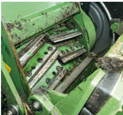
Bei der neuen Trommel mit größerem Förder-volumen sitzen die Messer unter den Haltern.
