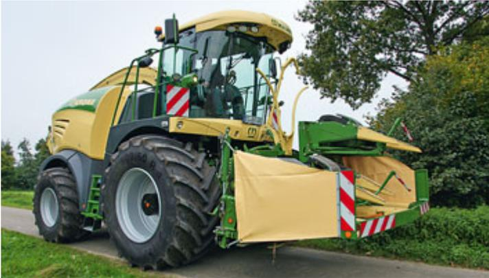
Schmal auf der Straße: 3,30 m mit 900er (Foto) und nur 3 m mit 710er Bereifung auf der Vorderachse.
