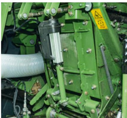
Per Stellmotor und Klappe lässt sich die Wurf-leistung zum Anhäckseln erhöhen.
