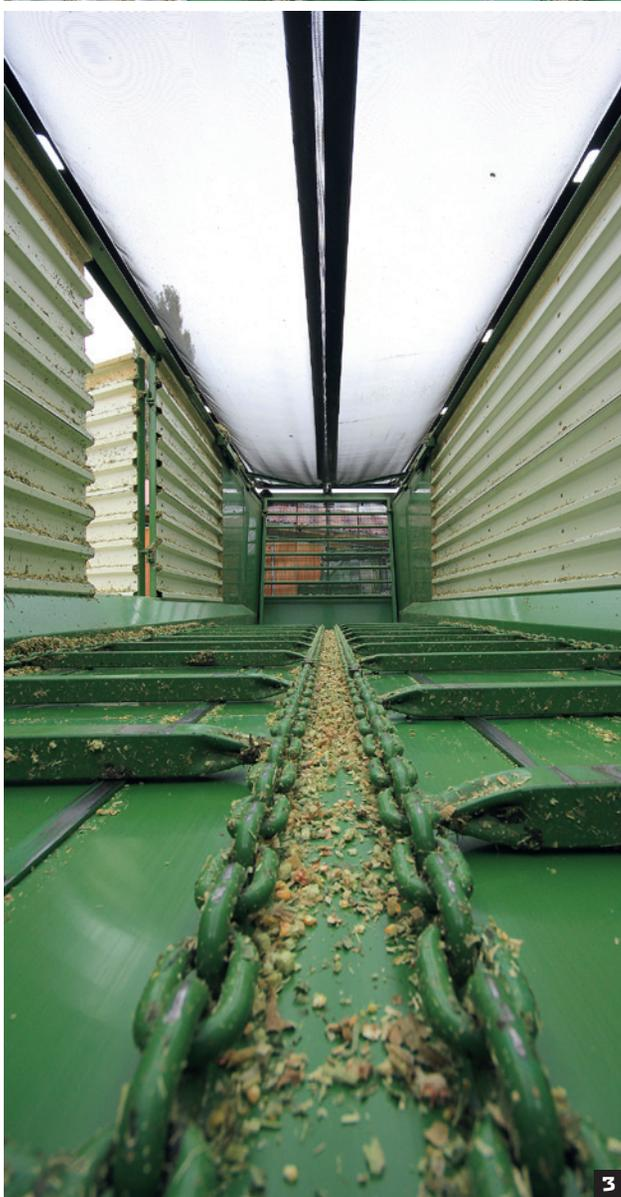
**1** Der abgesenkte Kratzboden erhöht das Ladevolumen. Auf den Stegen der Seitenwände sammelt sich zu viel Material an.
