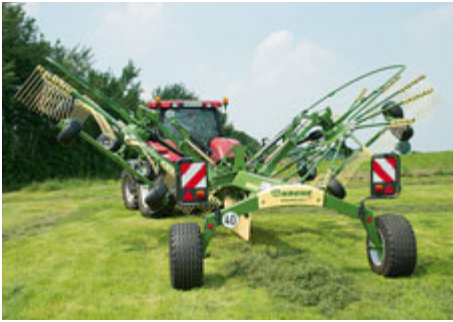
Die Zinkenarme brauchen nicht mehr abgeklappt zu werden, um die Transporthöhe unter 4 m zu halten. Mit der Arbeitsbreitenverstellung wird der Schwader abgesenkt und gleichzeitig verriegelt – schön.
