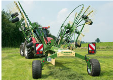
Die Zinkenarme brauchen nicht mehr abgeklappt zu werden, um die Transporthöhe unter 4 m zu halten. Mit der Arbeitsbreitenverstellung wird der Schwader abgesenkt und gleichzeitig verriegelt – schön.
