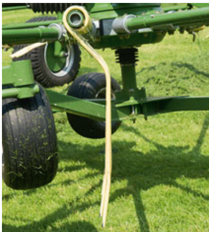
Die Zinken sind auf Griff gestellt. Diese „Liftfunktion“ soll das Futter anheben und schnellere Arbeitsgeschwindigkeiten ermöglichen. Letzteres können wir nicht bestätigen.
