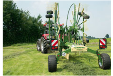
Die Zinkenarme brauchen nicht mehr abgeklappt zu werden, um die Transporthöhe unter 4 m zu halten. Mit der Arbeitsbreitenverstellung wird der Schwader abgesenkt und gleichzeitig verriegelt – schön.
