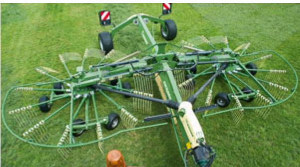
Die Kraft wird mit einem Y-Getriebe auf die 3,60 m großen Kreisel übertragen. Die Kreisel sind kardanis aufhängt und passen sich mit dem (aufpreispflichtigen) Sechsradfahrwerk dem Boden sehr gut an.
