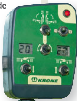
Die „Plus“-Variante ermöglicht den Einzelkreiselaushebung. Die beiden Skalen geben in etwa die Rechthöhe in Millimeter an.
