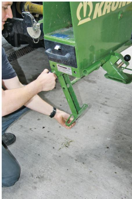
Zum Abstellen des Heckmähwerks in Transportposition werden für einen sicheren Stand vier FüÙe benötigt.
