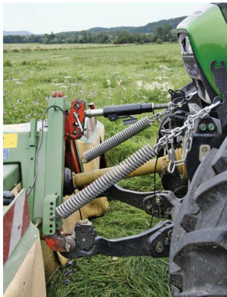
Die geschobene Mähwerksaufhängung ist ein Kennzeichen des EasyCut F 320 M. Auch hier erfolgt die Entlastung über Federn, die seitlich der Motorhaube eingehängt werden.
