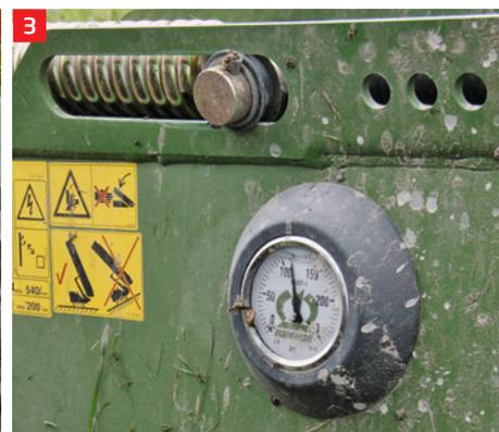
**1** Das Mähwerk wird nach dem Prinzip DuoGrip im Schwerpunkt geführt. In Arbeitsstellung soll das Lenkerparallelogramm waagrecht zum Boden stehen.
