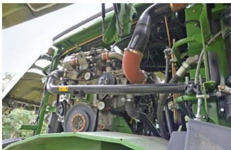
Unter der Haube arbeitet bei den neuen Modellen MTU Motorentechnik mit maximal 489 PS beim BiG X 480 bzw. 585 PS beim BiG X 580.
