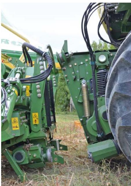
Die Kopplung der Vorsätze ist durch neue Aufnahmepunkte am Vorpressegehäuse sowie am Vorsatz deutlich vereinfacht worden. Der Antrieb des Vorsatzes wird automatisch über einen Schnellkuppler verbunden.
