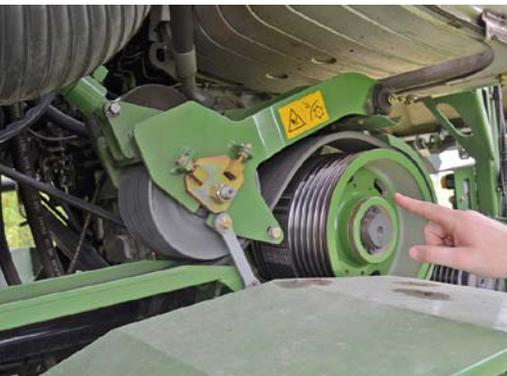
Die Guflusskomponenten werden bei den neuen Modellen über einen Riemenspanner zu- bzw. abgeschaltet. Dadurch kann auf eine Kupplung verzichtet werden.
