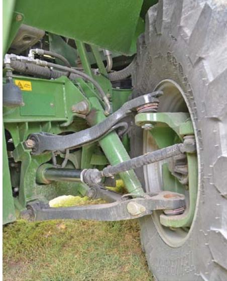
Die Hinterräder sind einzelradaufgehängt und hydraulisch gefedert. Durch den Lenkeinschlag von 50° ist der neue BiG X sehr wendig am Vorgehende.
