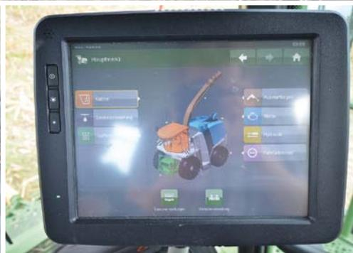
Der neue Monitor (links) verfügt über einen Touchscreen. Er lässt sich zusätzlich über Tasten und einen Dreh-/Drückschalter auf der Seitenkonsole bedienen (links außen). Über den grünen Drehschalter wählt der Fahrer den Fahrmodus vor.
