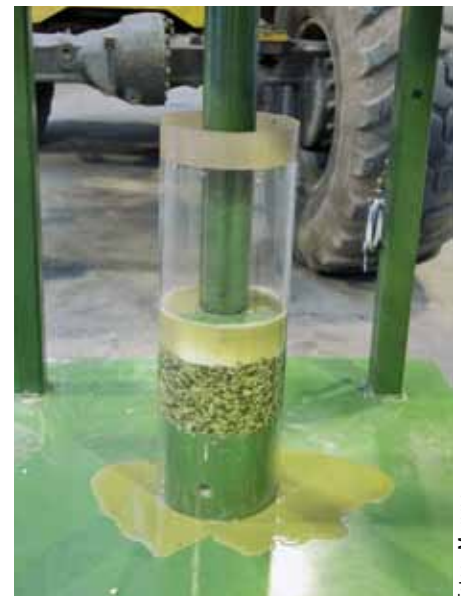
Mit einem 500 kg schweren Stempel haben wir den Mais verdichtet. Beim grünen Mais waren unabhängig von der Häckselänge starke Sickersaftverluste erkennbar (Bild unten).
