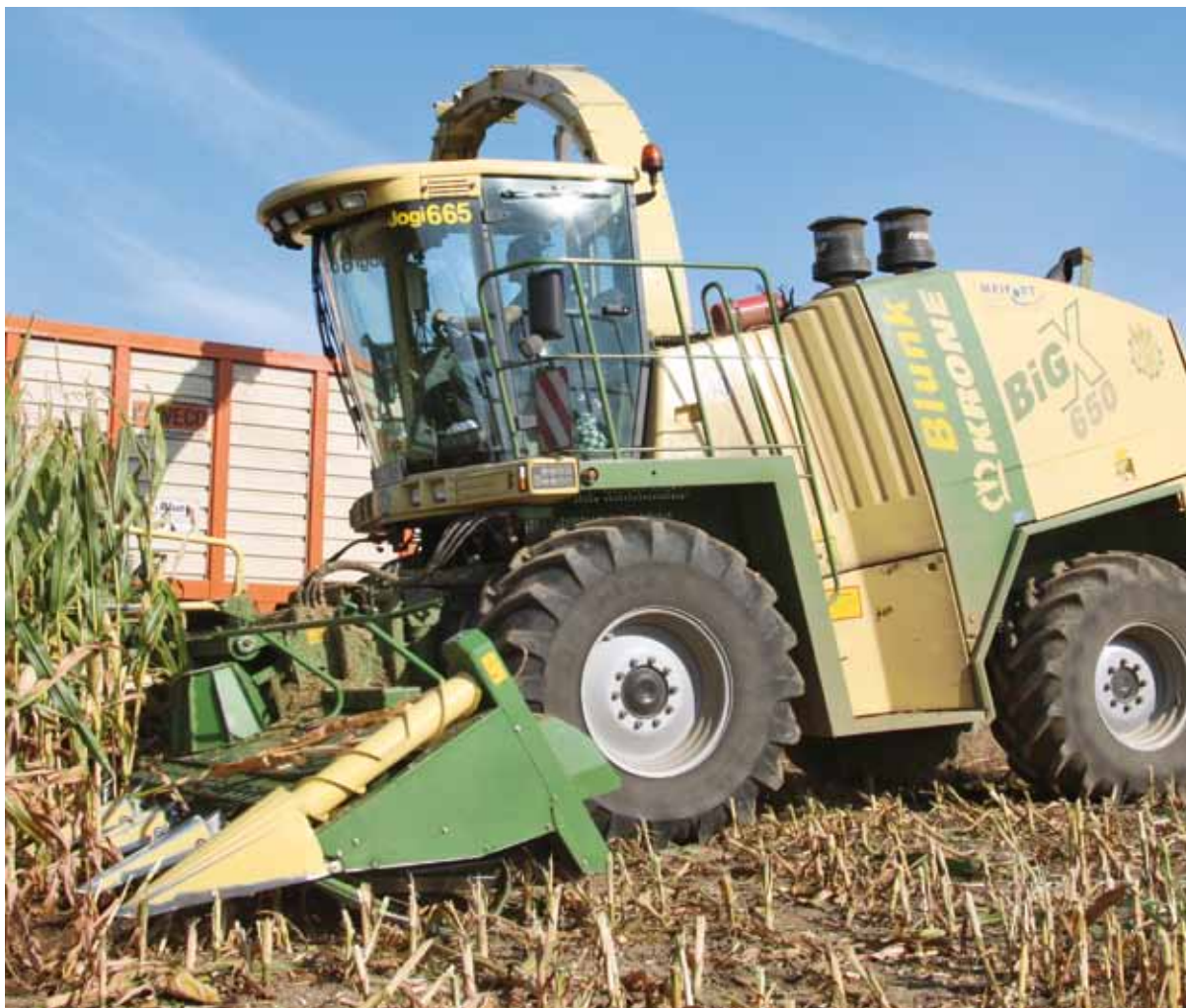
Der BigX mit EasyCollect besitzt ab Werk den Reifegradsensor AutoScan zur automatischen Schnittlängen Anpassung.
