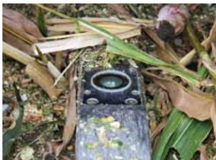
Der Optosensor sitzt mittig im Einzugskanal des Maisgebisses (linkes Bild). Vom Monitor aus kann der Fahrer Schnittlängenintervalle vorgeben und auch während der Fahrt verändern. Seit diesem Jahr reichen zwei Eingabefelder für die Berechnung der Regelkurve.
