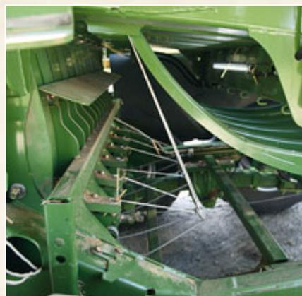
*Le berceau d'aiguille est très accessible grâce aux caissons escamotables et éclairés par des LED !*
