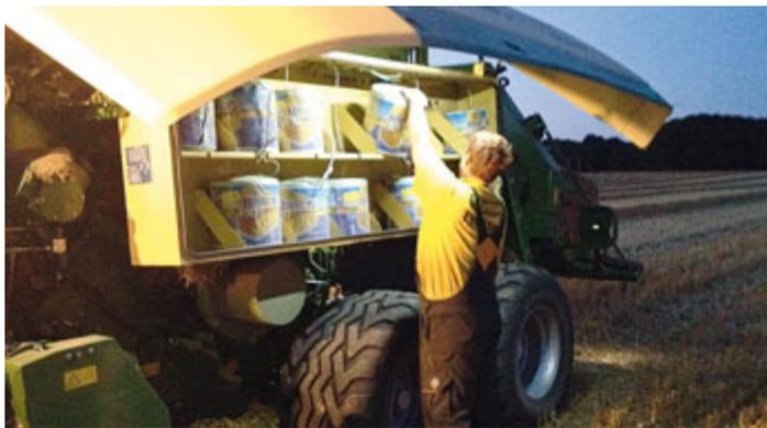
*Les caissons à droite et à gauche contiennent 32 rouleaux et possèdent même un éclairage LED. En option on peut ajouter 2 x 6 rouleaux.*
