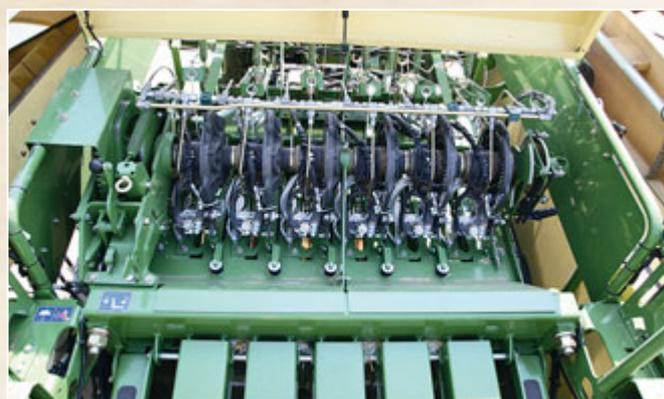
*Les six nouveaux doubles se sont révélés fiables à l'usage mais le nettoyage à air comprimé pourrait être plus puissant. L'équipement « Multibale » permet en plus de diviser une grosse balle en plusieurs petites balles.*
