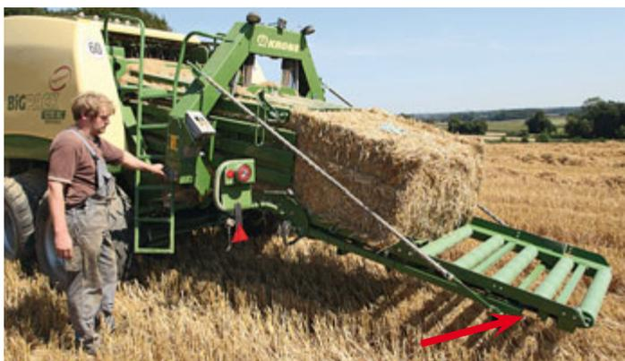
*L'éjecteur de balle et la glissière sont manœuvrés avec une simple touche à l'arrière sur le canal de pressage. Au total quatre de ces barres déterminent le poids de la balle pendant le travail avec moins de 2% d'écart.*
