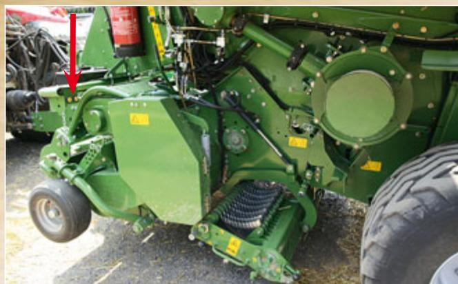
*Le porte-couteau se manœuvre facilement avec une simple touche. Ensuite il est possible de faire coulisser de côté le compartiment de 13 couteaux. À droite de l'image, l'accouplement débrayable de l'ameneur du système VFS qui effectue désormais - comme le piston de la presse - 45 au lieu de 38 mouvements /min.*
