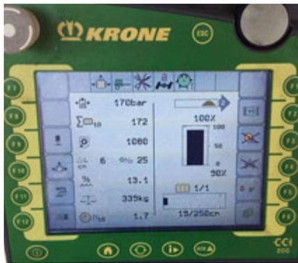
Sur le terminal CCI compatible ISOBUS à écran tactile il est possible d'afficher non seulement le poids de la balle en cours, mais également son humidité et toutes les autres données intéressantes. Malheureusement il est impossible de donner un nom aux 20 compteurs de balles.
