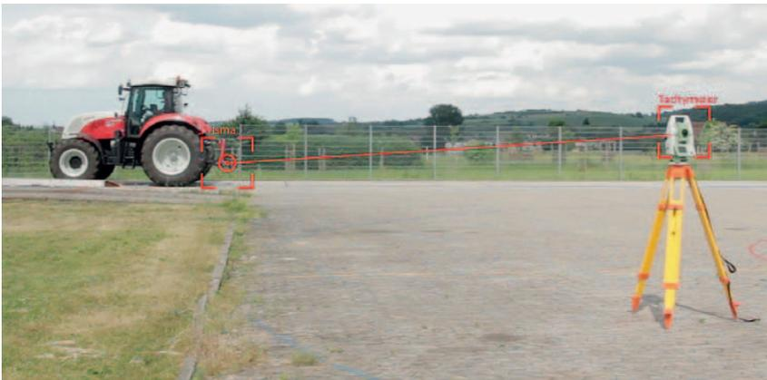
Bild 2: Messaufbau des optischen Referenzsystems
