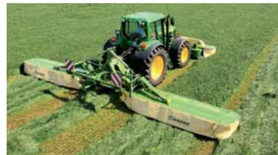
Das leichte EasyCut B 970 ohne Aufbereiter hat eine Arbeitsbreite von maximal 9,65 m. Es arbeitet wie auch frühere Modelle mit Schwerpunktaufhängung und zusätzlicher seitlicher Führung.
