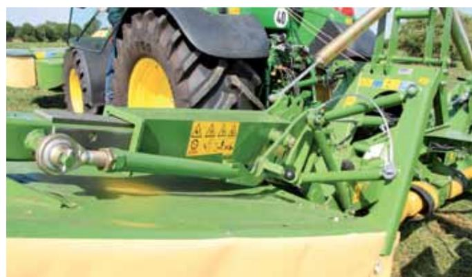
Der Versatz der Heckmäheinheiten lässt sich durch Umstecken von Hebeln in der Klappkinematik um jeweils zweimal 8 cm ändern.
