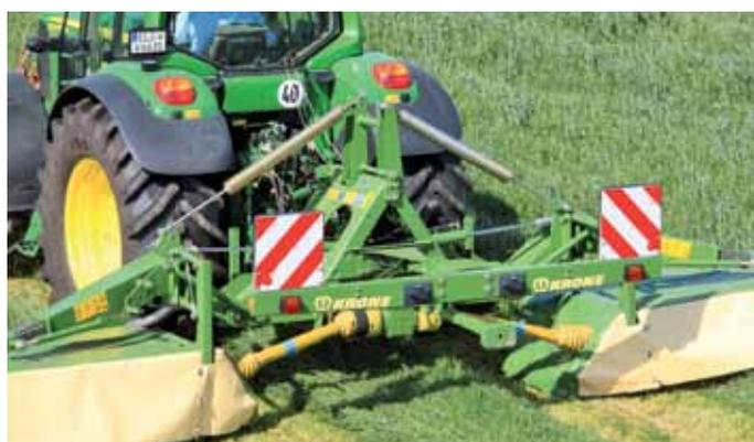
Die mechanische Entlastung mit Spiralfedern am EasyCut B 970 ist bekannt. Die zentrale Ausgleichsschwinge hat Vor- und Nachteile.
