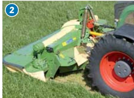
Konstruktion mit Federentlastung und Gasdruckdämpfer wurde beibehalten. Serienmäßig halten vier Leittrommeln den Schwad in Form. Die inneren Trommeln lassen sich mit Aufsätzen ausrüsten, um einen schmaleren Schwad zu bekommen (Zusatzrüstung).
