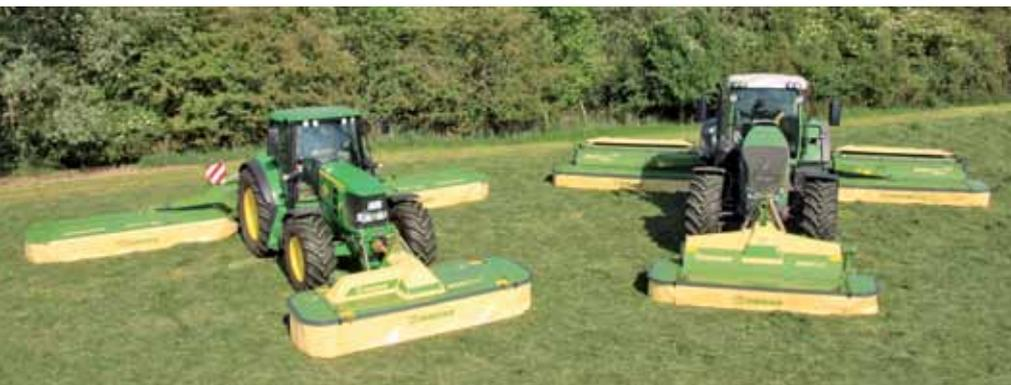
Zwei neue aufgelöste Mähkombinationen mit 9,65 und 10,10 m Arbeitsbreite zeigt Krone auf der Agritechnica in Hannover. Die Frontmäherwerke wurden überarbeitet.
