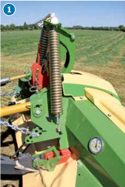
1 Die Entlastung und den Anbau beim CV-Float-Frontmähwerk hat Krone intensiv überarbeitet.
