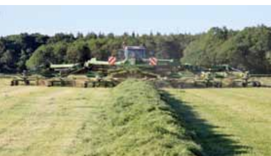
Mit einem Swadro 2000 wurde das Schnittgut gleichmäßig von 19 m Arbeitsbreite zusammengeswadet. So kam bei einem Ertrag von 38 dt TM/ha ordentlich Futter ins Schwad (6 bis 7,4 kg TM/m), um den BiG X 700 in der Motordrückung fahren zu können.
