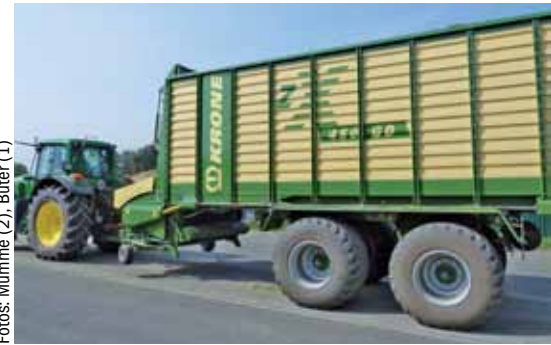
Aus den auf der Brückenwaage ermittelten Massen konnten wir unter Berücksichtigung des TS-Gehalts den theoretischen Durchsatz und den Verbrauch je Tonne Durchsatz ermitteln.
