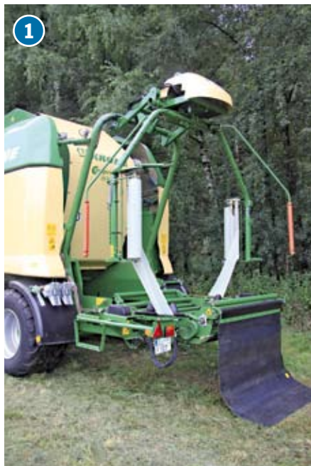
1 Der Wickler passt sich in der Höhe immer dem tatsächlich gepressten Ballendurchmesser an. Zur Straßenfahrt wird er hydraulisch abgesenkt.
