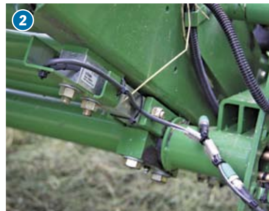
1 Die gekippte Ballenkammer (1) soll den Ballenauswurf verbessern. Am Hang aktiviert sich der Auswerfer (2) selbsttätig. 2 Für die optionale Ballenwaage muss man 3.780 Euro auf den Tisch legen. Der Zähler kann die Ballengewichte auch summieren und errechnet die Pressdichte.
