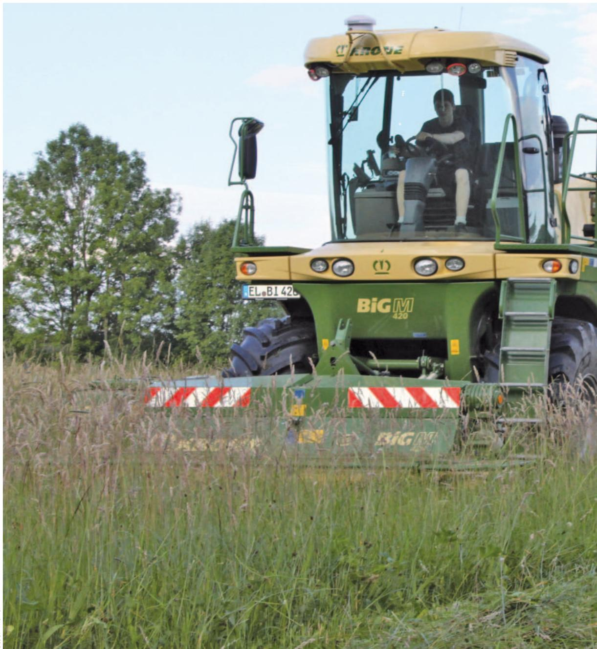
Zum Vorgänger hat sich einiges getan. Auf den ersten Blick fällt die größere Kabine mit deutlich besserer Übersicht und überarbeitetem Multifunktionsjoystick auf. Etwas versteckter findet man einen neuen CommonRail-Reihen-6-Zylinder von MAN mit 420 PS, 10,6 l Hubraum und SCR-Technologie.
