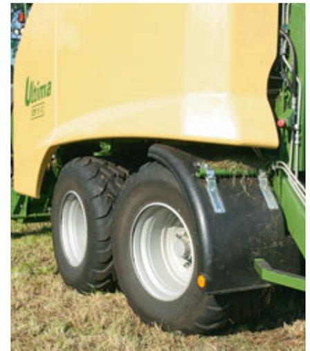
*Die Nachlauflenkung schont die Narbe, die Tandemachse ist mit großzügigen 620/40 R 22.5-Reifen versehen.*
