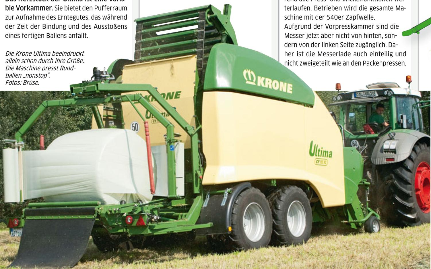
Dann landet das Material in der Vorpresskammer, die mit 1,20 m genauso breit ist wie der Einzug. Die Kammer ist variabel, sie nimmt je nach Arbeitsphase eine konische oder eine rechteckige Form an.
