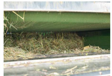
*Der Blick in die Vorpresskammer mit den Förderbändern, zur Veranschaulichung wurde hier die beschriebene Reversierung aktiviert.*
