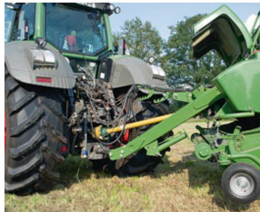
Die Knickdeichsel wie bei den Ladewagen verbaut Krone erstmalig bei einer Press-Wickel-Kombination. Angehängt wird über die K80-Kugel.
