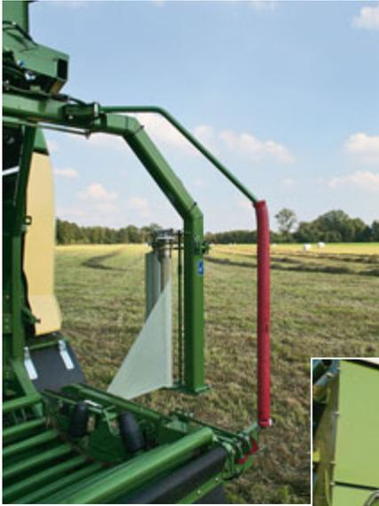
*Die Wickelarme selbst wurden verstärkt und bestehen jetzt aus Quadratrohr, der Antrieb wurde für mehr Geschwindigkeit ebenfalls geändert.*
