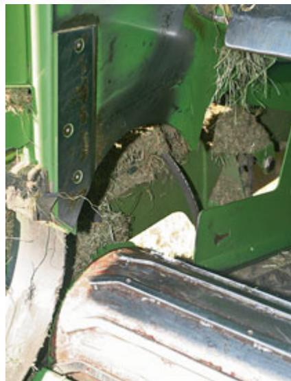
*Die untere Walze der Presskammer kann zusammen mit der Vorpresskammerunterseite abgesenkt werden.*
