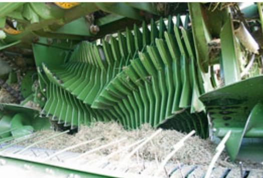
*Der aus den AX-Ladewagen bekannte 750-mm-V-Rotor spielt die Schlüsselrolle bei der Befüllung der Vorpresskammer.*
