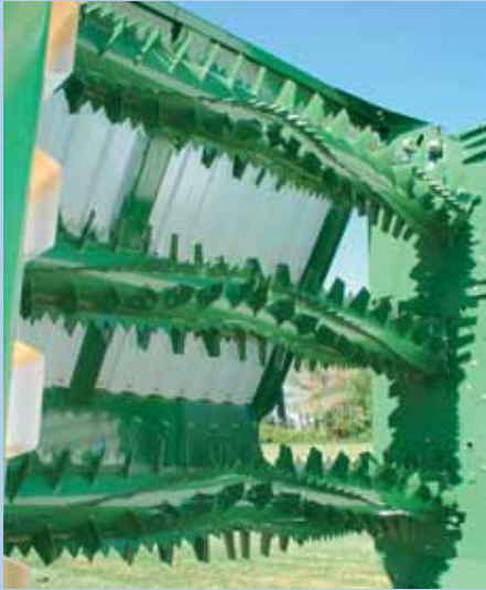
Beim ZX 450 GD sind drei Dosierwalzen Serie. Die Nockenschaltkupplung löst jetzt später aus. Das passt.
