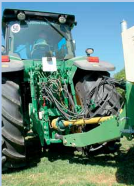
Die Untenanhängung macht Sinn. Allerdings fällt die Deichsel kurz aus. Das stört bei Traktoren mit großer Spurweite.
