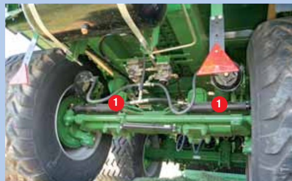
Das Fahrwerk mit der hydraulischen Abstützung (1) ist Serie und sorgt für eine stabile Lage auch am Seitenhang.
