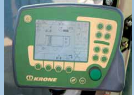
Der Monitor ist eine gelungene Schaltzentrale auf ISO-Bus-Basis. Die Symbole auf dem Display könnten aber größer ausfallen.
