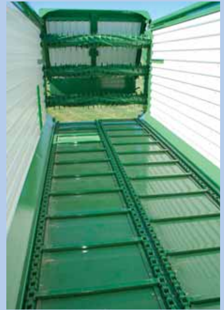
Vier Flachgliederketten mit je 12,5 t Bruchkraft sind Standard beim ZX 450, ebenso der Boden aus Metallblech.
