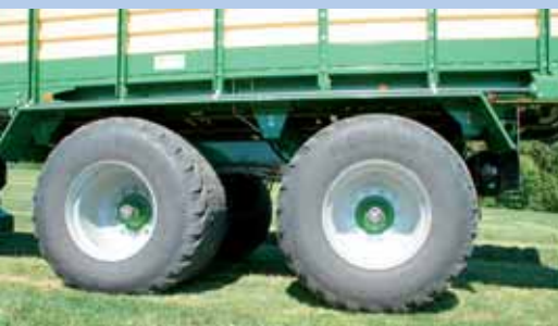
Die 800/45 R26.5-Räder tragen gut. Der große Durchmesser sorgt aber auch für 395 cm Fahrzeughöhe. Das Tandempaket erlaubt 23 t. Das ist knapp für den ZX 450.
