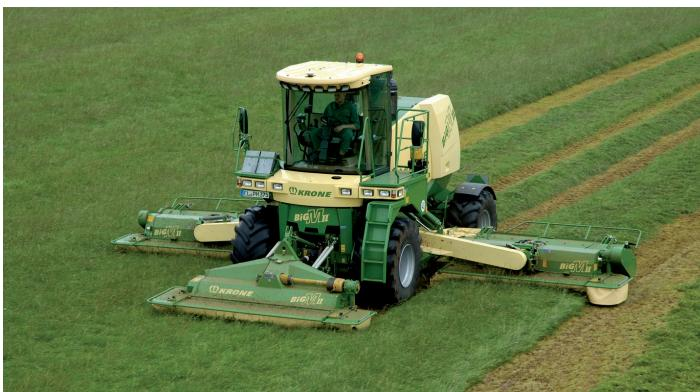
*BiG M обеспечивает высокую производительность при укосе. Три косилки этой машины могут быть оснащены плющилками для сокращения периода подвяливания.*
