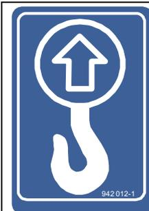
На машине имеются точки подъема, обозначенные этим указательным знаком, см. в главе "Движение и транспортировка" раздел "Подъем машины".
