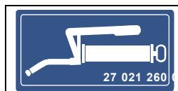
На машине имеются несколько точек смазки, которые необходимо регулярно смазывать, см. главу "Техническое обслуживание – смазывание". Скрытые точки смазки дополнительно обозначены этим указательным знаком.
