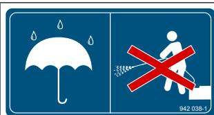
Участки, отмеченные этим указательным знаком, должны быть защищены от брызг воды. В особенности запрещается направлять струю воды установки для чистки под высоким давлением на подшипники и компоненты электрики/электроники.
