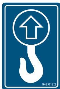
На машине имеются точки крепления при транспортировке, обозначенные этим указательным знаком, *см. Страница 132.*
