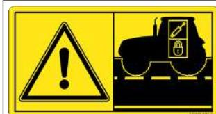
**Опасность из-за незаблокированных управляющих клапанов трактора**
