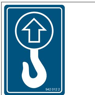
На машине имеются точки крепления при транспортировке, обозначенные этим указательным знаком, см. [Страница 78](#).
