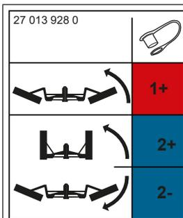
Наклейка отмечает возможные гидравлические подключения машины. Дополнительная информация о подсоединении гидравлических шлангов: [см. Страница 57](#) и [см. Страница 45](#)
